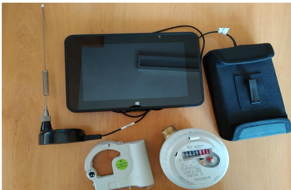
Zdjęcia: Wodomierz z nakładką radiową oraz systemem do zdalnego odczytu wodomierzy.
